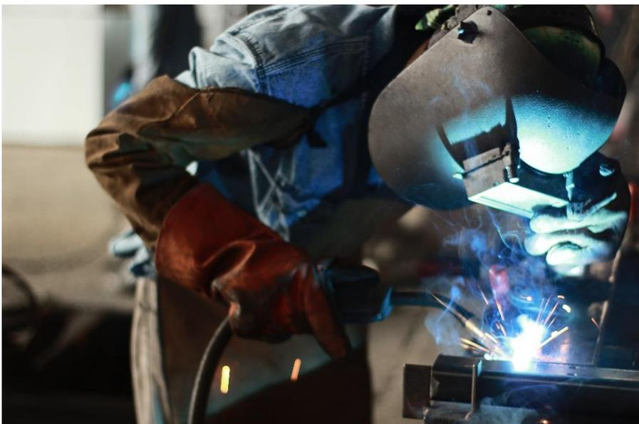
Pengelasan dilakukan sebagai proses *fitting*, menggunakan APD lengkap
