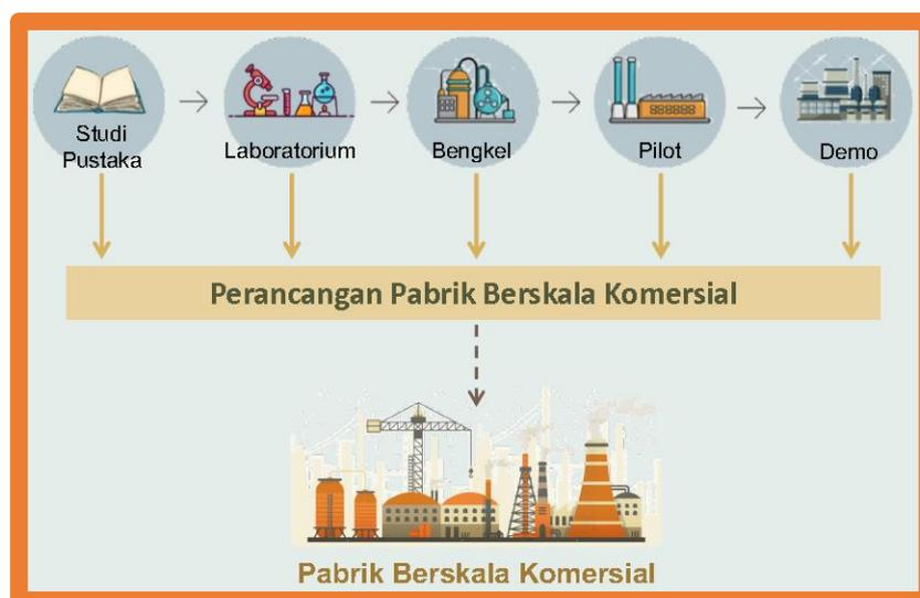
Gambar 6. Tahapan Pengembangan Teknologi Proses
